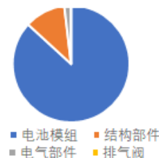
采用挤压铝型材拼焊箱体电池各部件相应的重量比例
